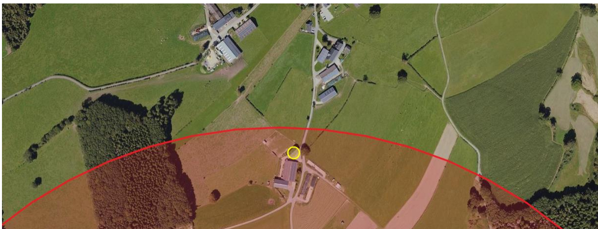
Abbildung 26: Darstellung des Bereiches mit potenziell optisch bedrängender Wirkung (dreifache Gesamthöhe = 799m) ausgehend von der WEA4 (rot) und der Position des Wohngebäudes (gelb) mit angrenzenden Hofgebäuden im Süden von Berlé. Quelle: http://www.geoportail.lu , 2025
