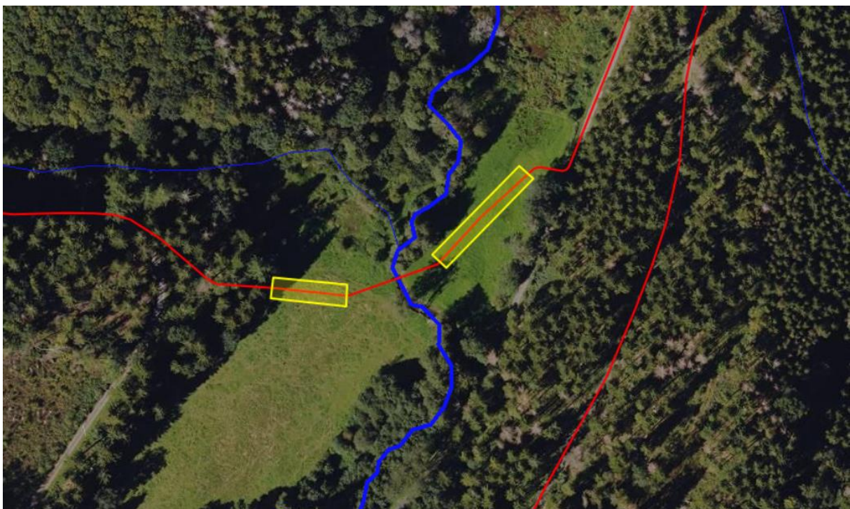
Abbildung 83: Mit Stahlplatten auszulegender Bereich der Einspeiseleitung bei der Bachquerung des Krupbeiwien.
