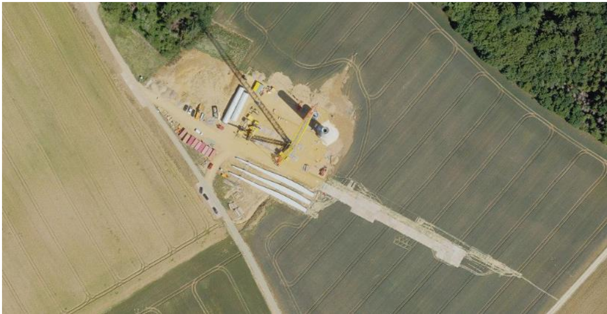
Abbildung 4: Luftbild 2023 von einer WEA-Baustelle (inkl. Kranaufrichtungsfläche) südlich von Welfrange in der Gemeinde Dalheim. Quelle: http://www.geoportail.lu , 2025
